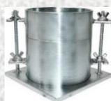
El molde de compactación modificado se utiliza para llevar a cabo el ensayo ASTM de la relación Humedad – Densidad de los suelos.
