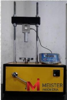
La máquina digital para Ensayos de Compresión Inconfinada es un equipo diseñado para aplicar cargas manualmente mediante una biela acoplada a una transmisión de engranajes situados en la base del equipo. La medición e indicación digital de fuerza nos permite ver la magnitud de la carga.
