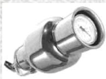
Permite para la determinación del contenido de humedad de suelos, arenas y áridos. Medición fiable y precisa de la humedad en campo, lectura directa en porcentaje de humedad.
