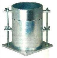
Se utiliza en la determinación de la resistencia a la penetración de un suelo en condiciones de Humedad / Densidad.
