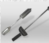
Sirve para determinar la fuerza de torsión necesaria para lograr que una superficie cilíndrica sea cortada por la veleta y así hallara la resistencia unitaria de dicha superficie.
