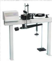
Sirve para realizar y registrar los ensayos, en las etapas de consolidación y corte, la función de salida de datos asegura al usuario la velocidad de los datos de la fuerza y deformación y facilita la impresión de resultados, directamente en una hoja de cálculo, mediante un software que permite el registro de todos los parámetros del ensayo, la captura en tiempo real de los datos.
