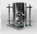
El molde de compactación abierto es similar en todos los detalles al molde Modelo AC 108, salvo que está abierto longitudinalmente y tiene abrazaderas especiales. Esta característica permite extraer fácilmente la muestra al finalizar el proceso de compactación.
