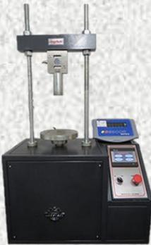
Resulta idóneo para ensayos rápidos triaxiales con drenaje, ensayos de compresión confinada, ensayos CBR y de estabilidad Marshall utilizando un solo marco de carga.
