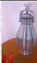
Permite para la determinación del contenido de humedad de suelos, arenas y áridos. Medición fiable y precisa de la humedad en campo, lectura directa en porcentaje de humedad.
