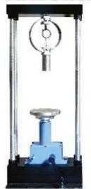
La prensa de carga CBR, se utiliza para forzar la penetración del pistón en a muestras compactada. La carga se aplica a través de un gato de tipo mecánico. La relación de engranaje del gato ha sido seleccionada para proporcionar una velocidad que a mano puede mantenerse cómoda, particularmente con suelos de alta resistente CBR. Incluye avance rápido para aproximación y retroceso.
