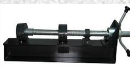
El extractor de muestras horizontal está diseñado para la extracción de las muestras en los tubos de paredes finas (tubos shelby). El extractor elimina la necesidad de cortar los tubos saca muestras para recuperar la muestra y ensayar.
