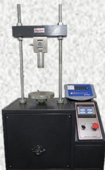
La máquina digital para Ensayos de Compresión Inconfinada es un equipo diseñado para aplicar cargas manualmente mediante una biela acoplada a una transmisión de engranajes situados en la base del equipo. La medición e indicación digital de fuerza nos permite ver la magnitud de la carga.
